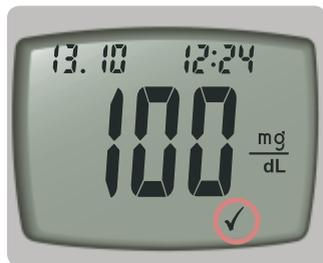
**REMARQUE :** Le ✓ n'indique pas que le résultat de la solution de contrôle se situe dans la plage de valeurs spécifiées. Il ne l'identifie que comme un test réalisé avec une solution de contrôle. Il ne sera pas pris en compte dans vos moyennes.
